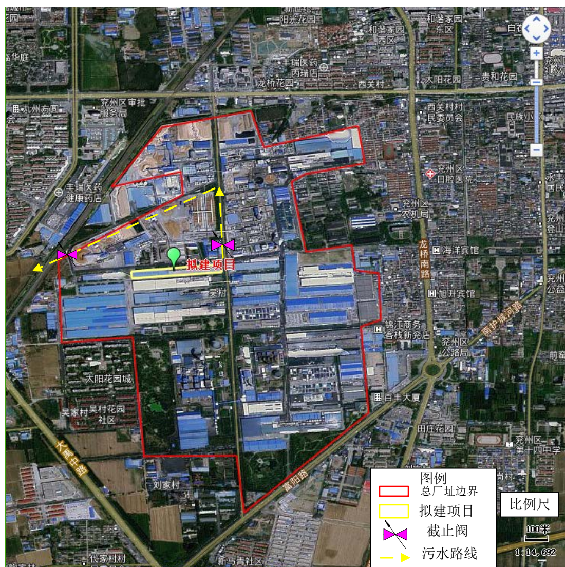
图 5.8-2 控制、封堵系统图
