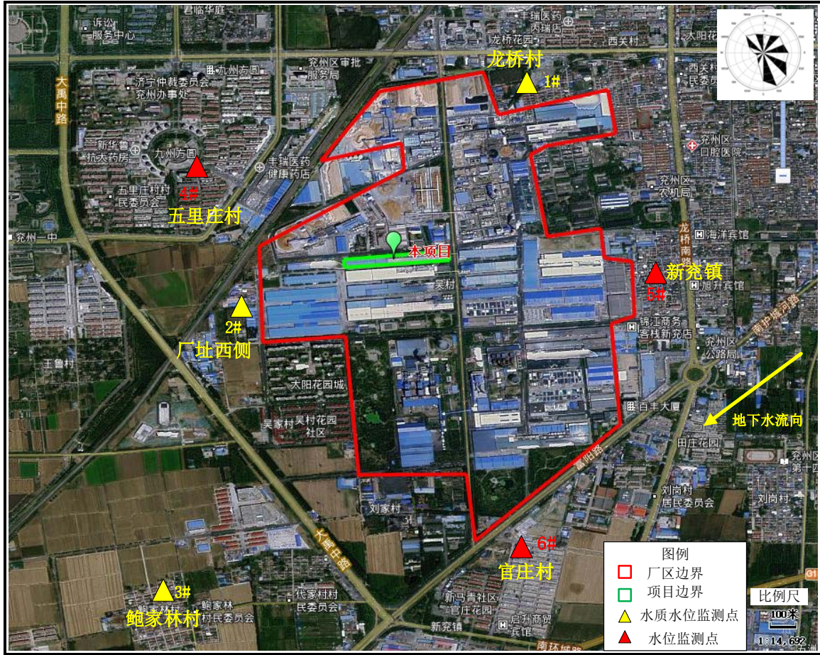
图 3.2-1 地下水监测布点示意图
