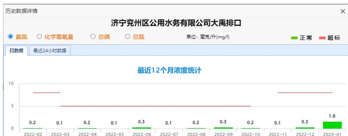
图 4-5 大禹污水处理厂最近 12 个月氨氮浓度统计情况
